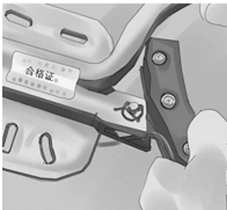
图 1-16 小爪应连接牢固
