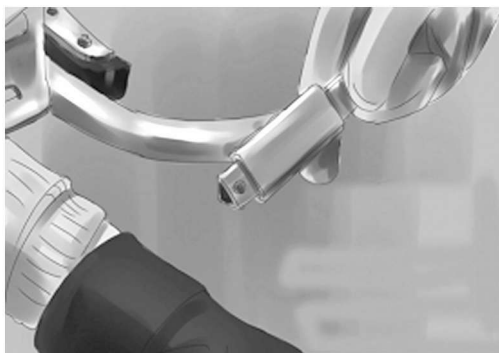
图 1-13 防滑块与金属件的连接
