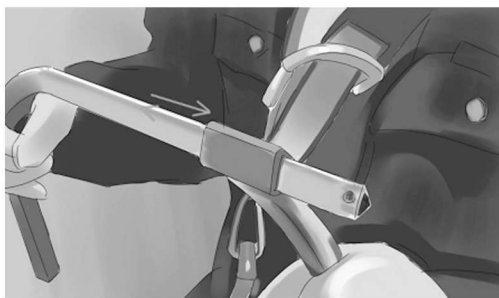
图 1-14 围杆钩在扣体内应滑动灵活
