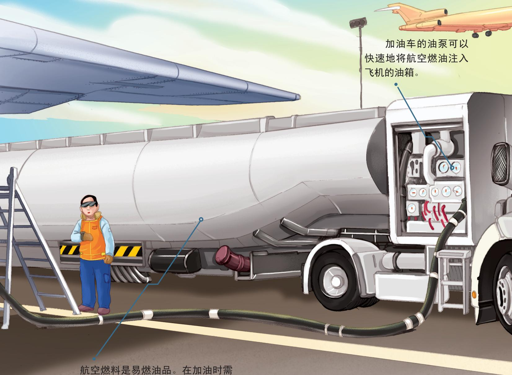
加油车的油泵可以快速地将航空燃油注入飞机的油箱。
