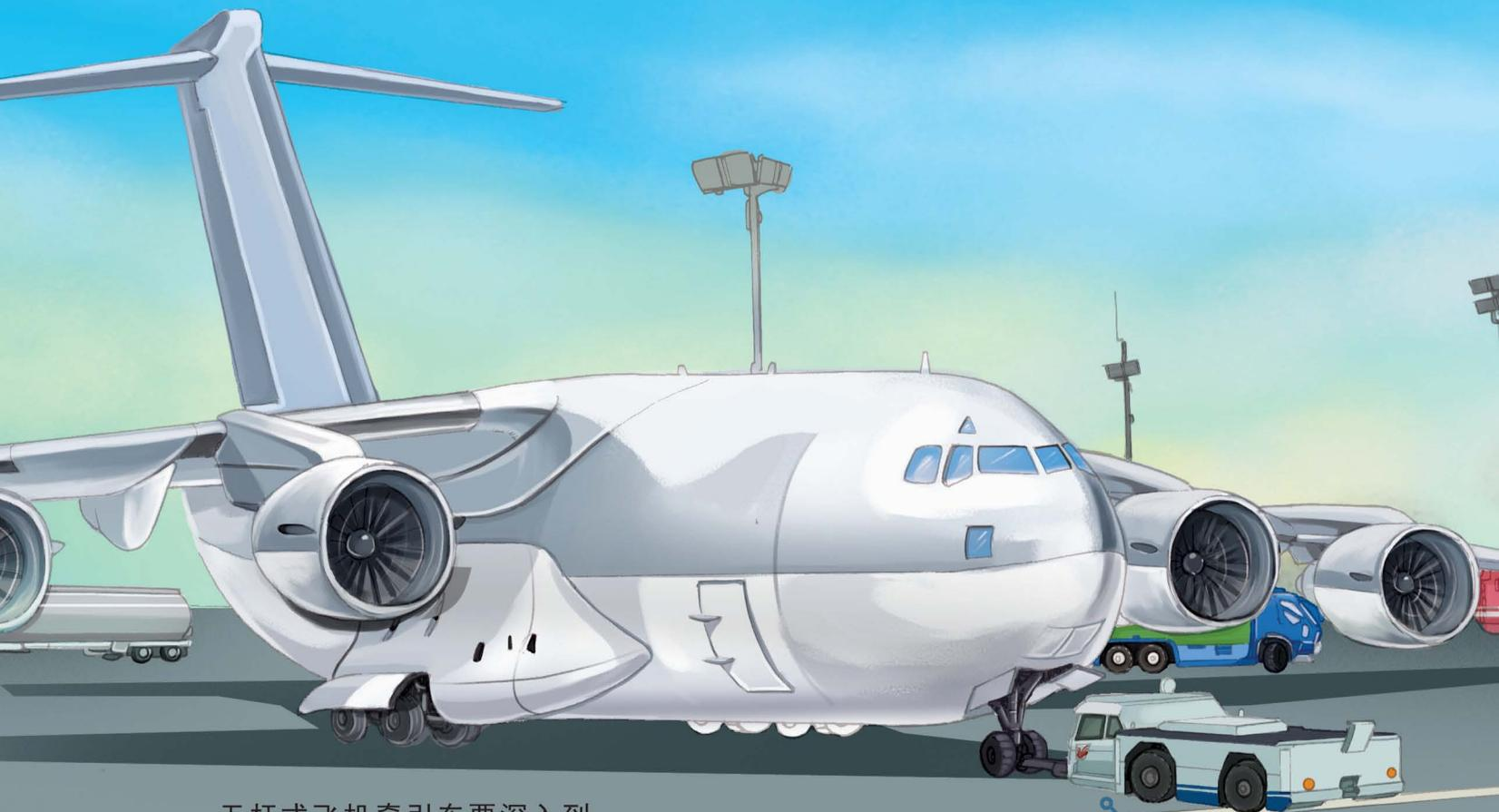
无杆式飞机牵引车要深入到飞机机头下方才能进行牵引工作，所以，它是个“矮个子”。
