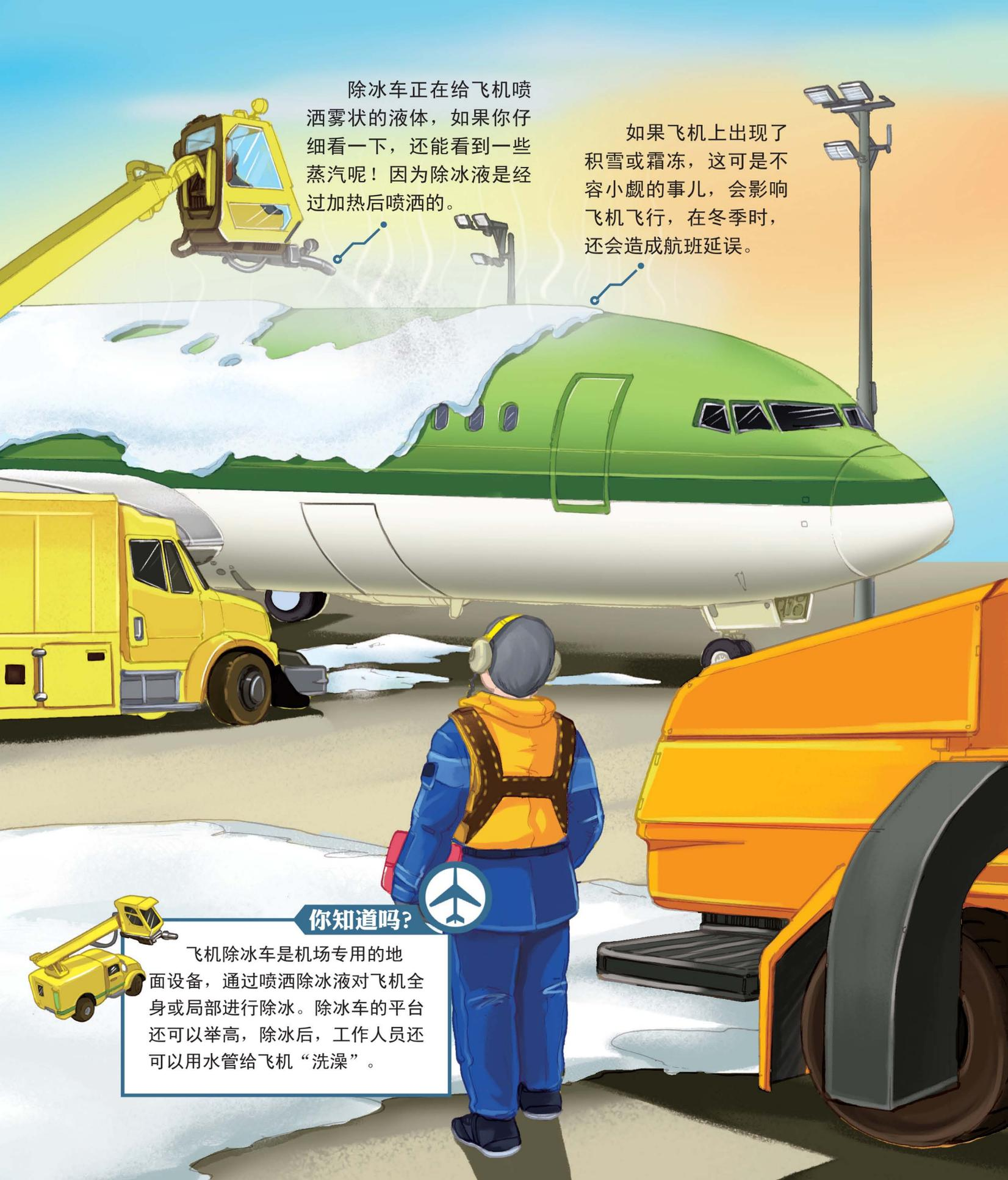
除冰车正在给飞机喷洒雾状的液体，如果你仔细看一下，还能看到一些蒸汽呢！因为除冰液是经过加热后喷洒的。
