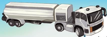
飞机油罐加油车是专用的加油车，配备了大容量油罐和大功率油泵，能给高出地面很多的飞机加满油。
