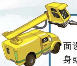
飞机除冰车是机场专用的地面设备，通过喷洒除冰液对飞机全身或局部进行除冰。除冰车的平台还可以举高，除冰后，工作人员还可以用水管给飞机“洗澡”。
