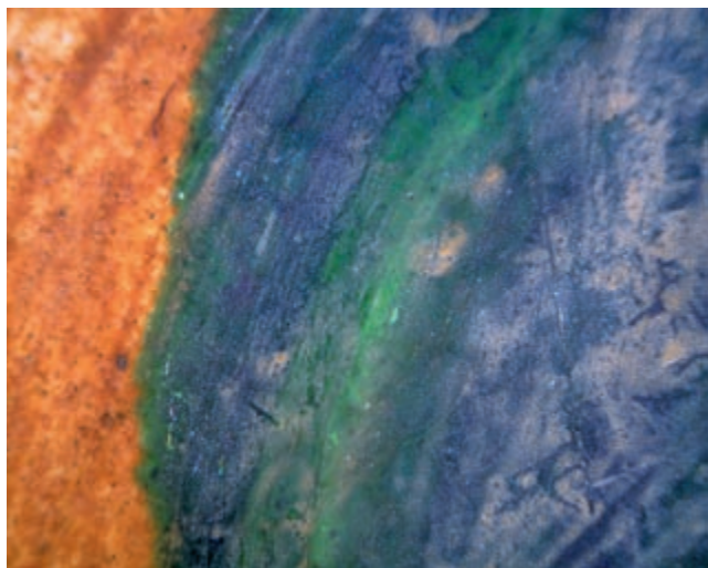
图1 显微镜下釉面土碱土锈
