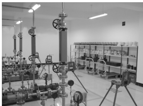
图 1-1-1 流体输送管路拆装实训装置 (UTB-CZLB)
