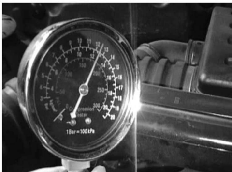
图 1-15 气缸压力检测（八）
