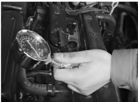
图 1-14 气缸压力检测（七）
