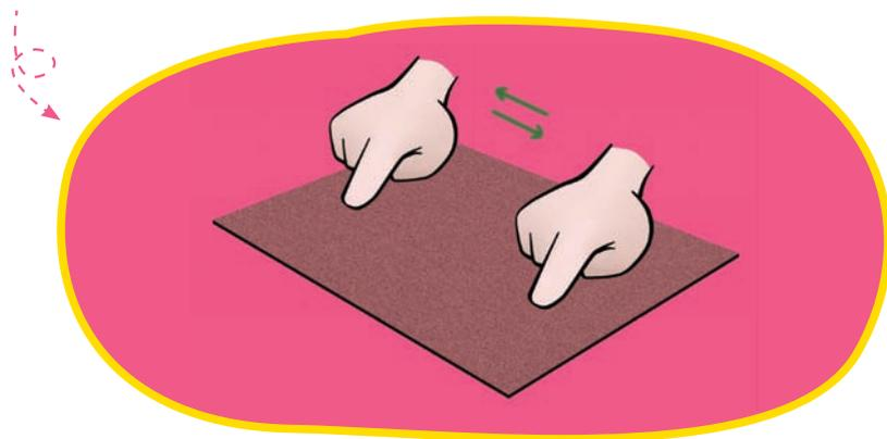
2. 捏住螺丝杆，将螺丝头平放在砂纸的一角上，然后朝着对角线方向用力摩擦几次。（不要来回摩擦，要朝着同一个方向进行摩擦。）
