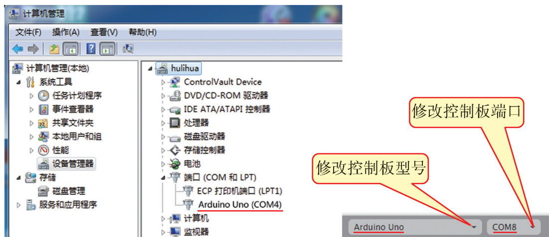
图1-13 设置Mixly软件与Arduino UNO控制板的通信配置
