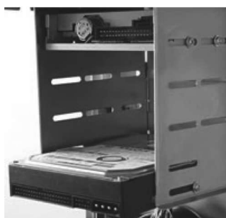
图 1-9 硬盘和光驱的安装
