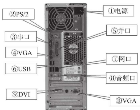
图 1-10 机箱接口示意图
