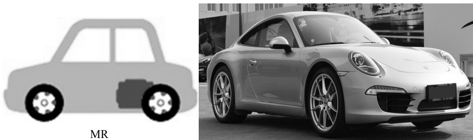
图 2-4 发动机中置后轮驱动
