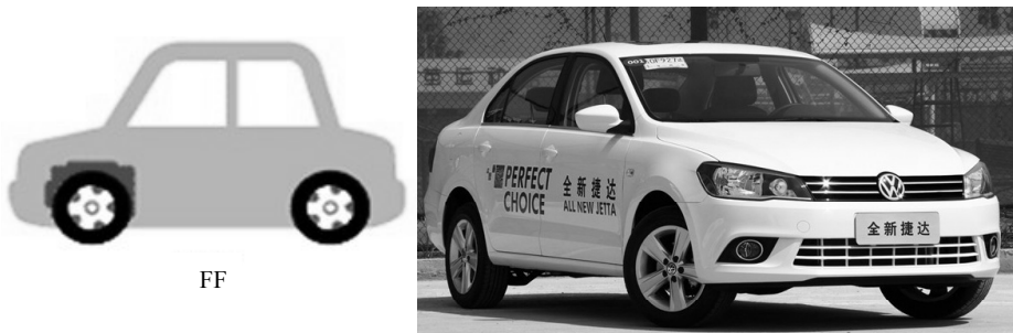
图 2-2 发动机前置前轮驱动
