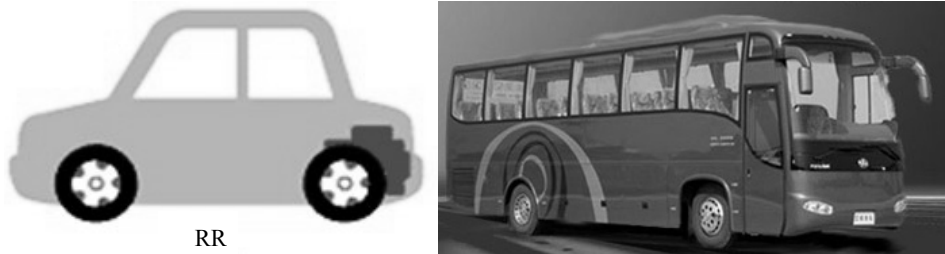
图 2-3 发动机后置后轮驱动
