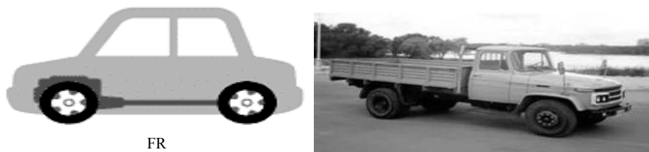
图 2-1 发动机前置后轮驱动
