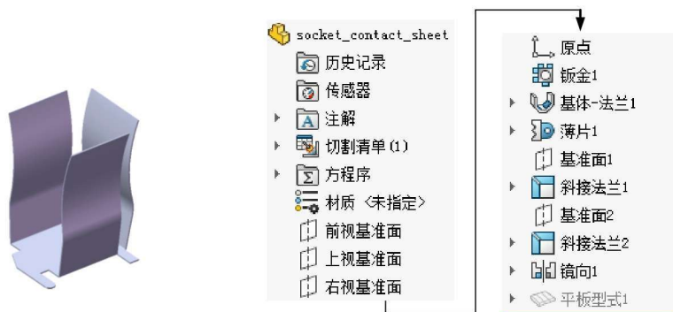
图 1.1 钣金件模型及设计树
