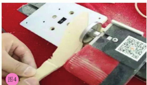
图4 使用磨床将小刀周围打磨光滑，磨出刀刃以及刀背上的锯齿，再使用钻床在刀把钻个6#的小孔。
