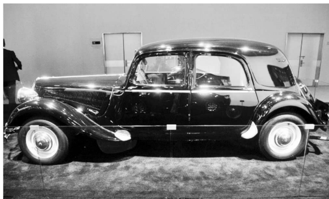
图 1-2-7 雪铁龙前轮驱动轿车，1934 年
