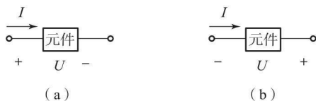
图1-9 电压参考方向与电流参考方向的关系
