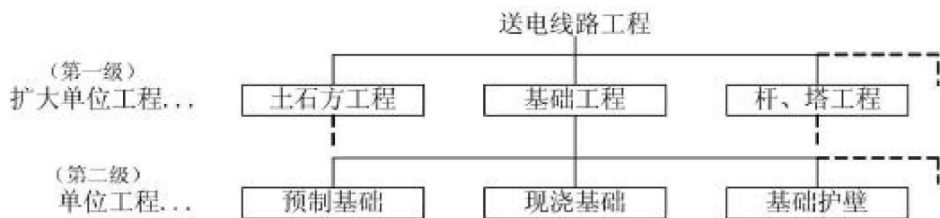
图 1-2 送电线路工程项目分解图示
