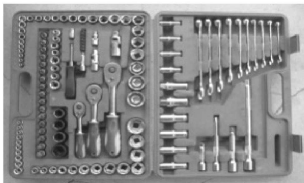
图 2-1-4 套筒扳手总成（150 件套装）
