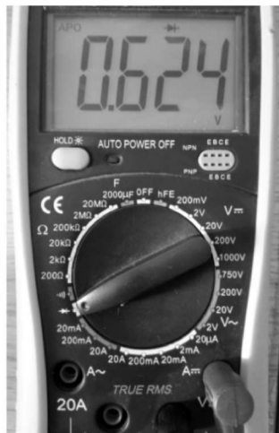
图 1.1.5 万用表测试二极管
