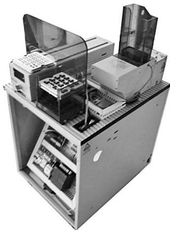
图1-1-15 安装好的上料整列单元
