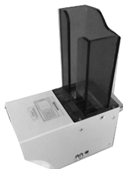
图1-1-11 底座上料机构
