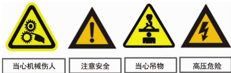
图 1-3 汽车维修厂常见警告和警示标志
