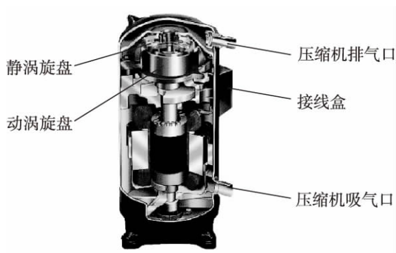
图 1-1-5 涡旋式压缩机
