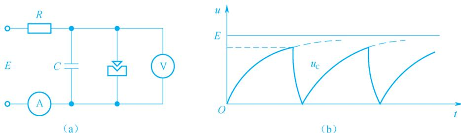
图 1-7  $RC$  线路脉冲电源
