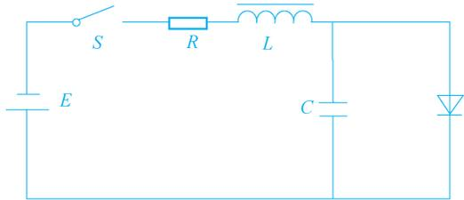
图 1-8 RLC 型脉冲电源电路
