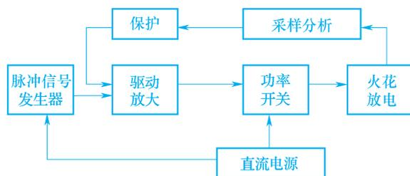
图 1-5 电火花脉冲电源工作原理
