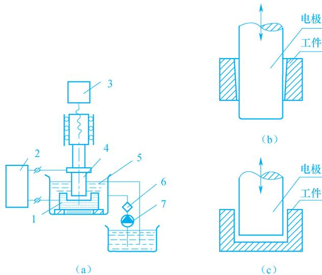
图 1-2 电火花加工原理
