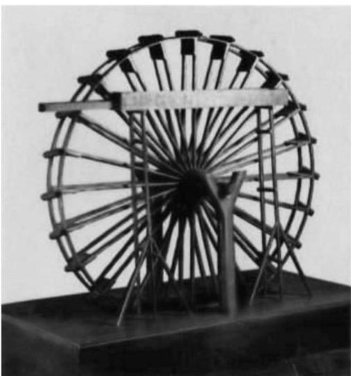
筒车是和翻车相类似的提水机具。这是利用湍急的水流转动车轮，使装在车轮上的水筒自动戽水，提上岸来进行灌溉。
