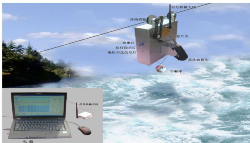
图 1-1 雷达波测速仪测流示意图
