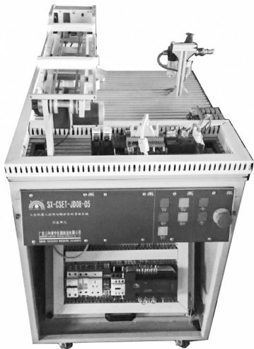
图1-1-7 安装好的检测排列单元
