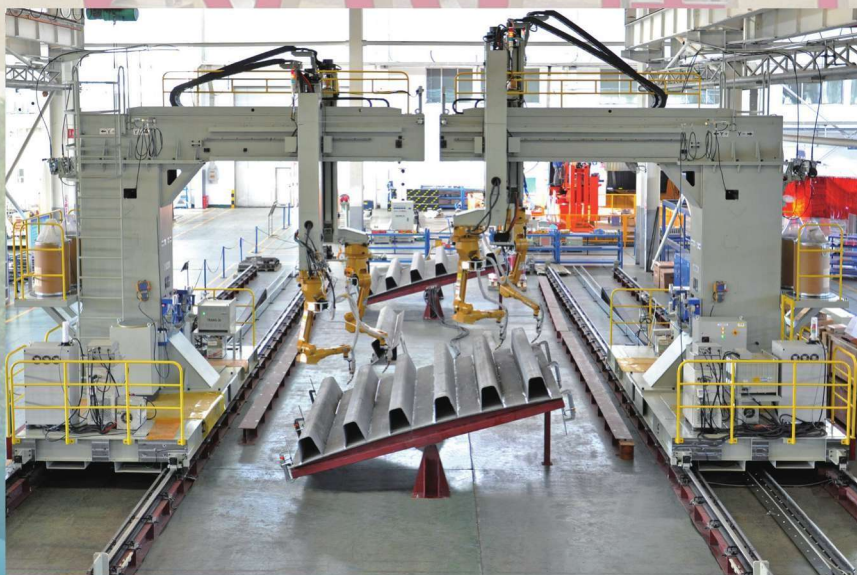
图为唐山开元集团U肋板单元机器人焊接系统。
