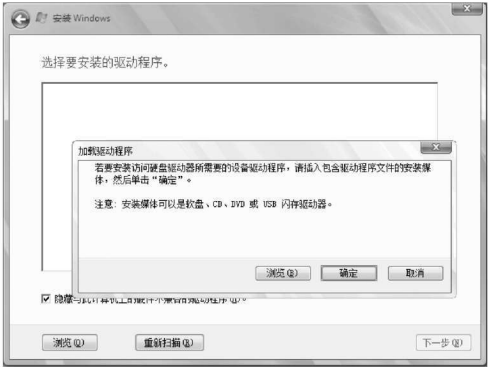
图 1-3 加载 RAID 驱动程序
