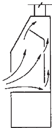
图 2-3 上下部同时排风通风橱示意图
