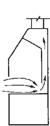
图 2-2 下部排风通风橱示意图
