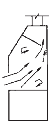
图 2-1 上部排风通风橱示意图
