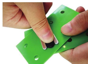
用大拇指按住铆钉，使用扳手轻轻撬起铆钉，拆卸连接片
