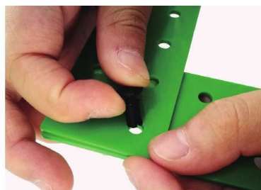
把铆钉对准上下两块板的孔，把铆钉穿进孔里
