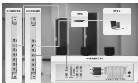
图 1.2.6 iBSC 电源及维护连线图
