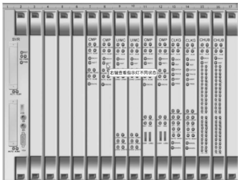
图 1.2.2 iBSC 控制框前面板示意图
