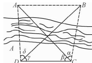
**例2** (教材 P13 例 3)  $AB$  是底部  $B$  不可到达的一个建筑物,  $A$  为建筑物的最高点, 设计一种测量建筑物高度  $AB$  的方法。
