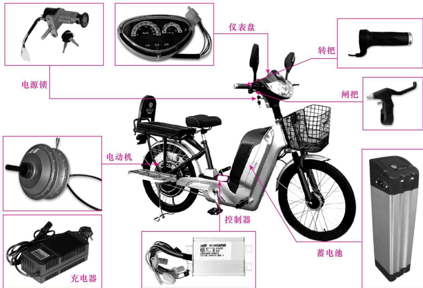
图 1-5 电动自行车电路系统的结构组成
