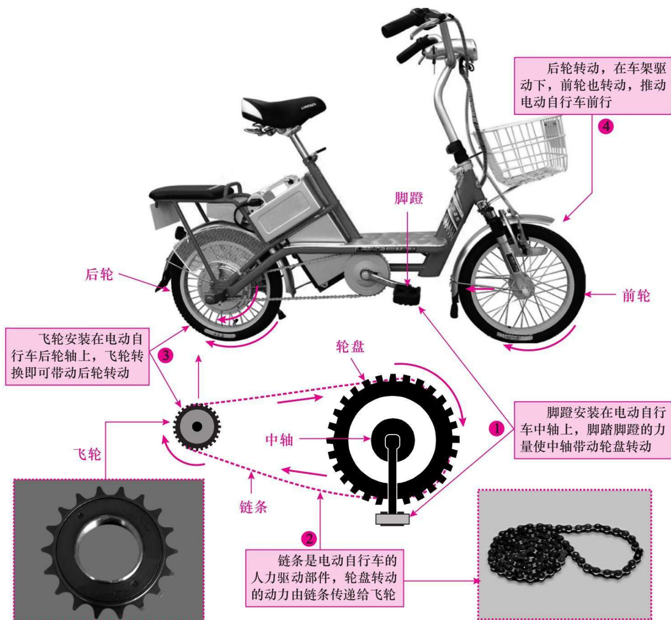
图 1-3 电动自行车的人力驱动部分
