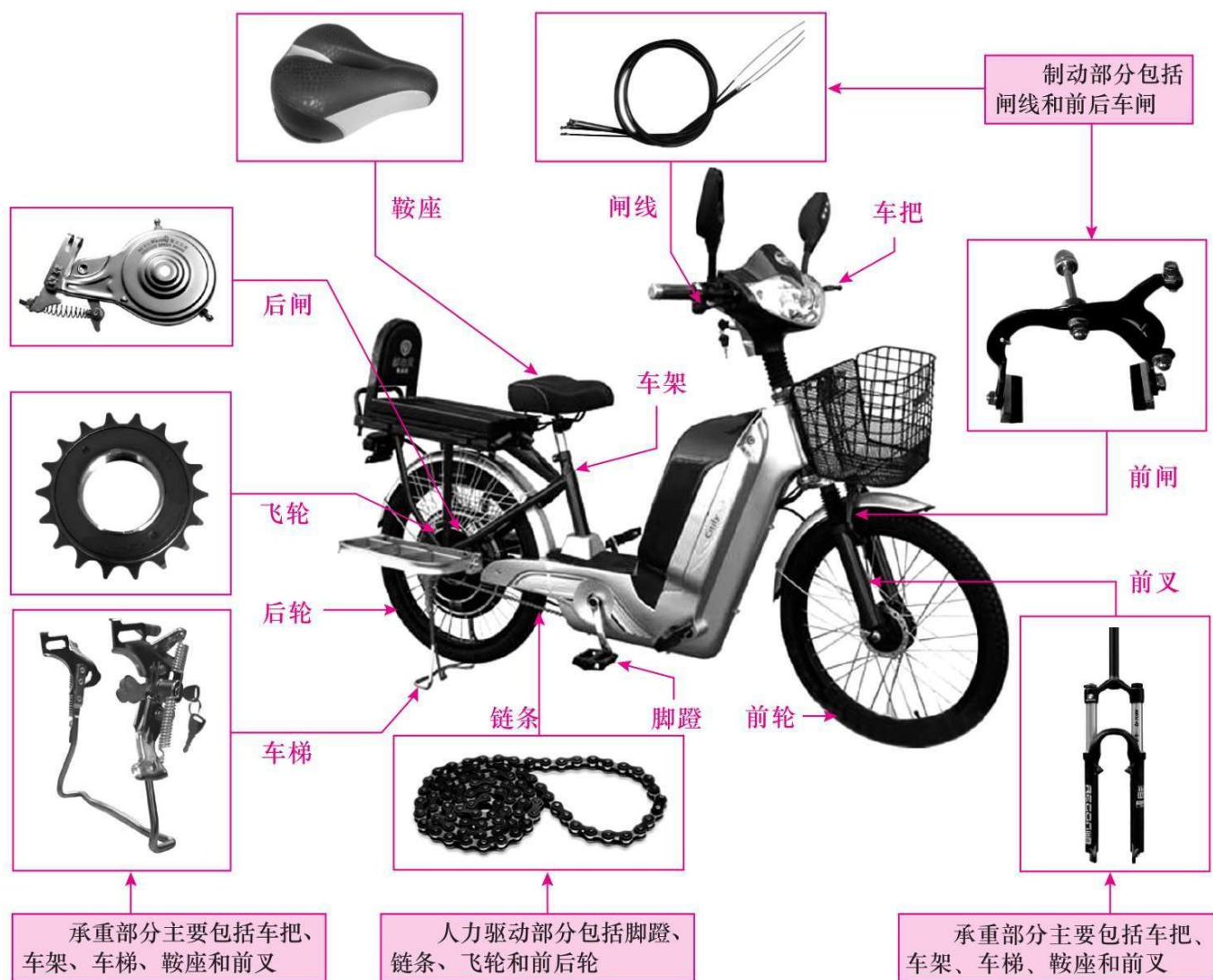
图 1-1 电动自行车机械系统的结构组成
