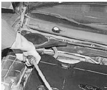
(6) 清洁干净溢出的冷却液
