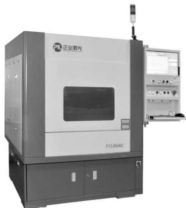
图 1-1 高速 CO 2 激光切割机
