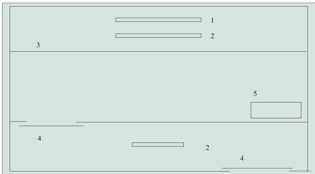
1. 照明灯 2. 紫外线灯 3. 接种工作台 4. 推拉门 5. 药品柜
