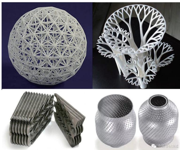
图 1.3 3D 打印突破传统几何约束
