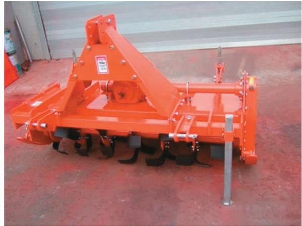
挡土罩等处的积泥油污;拧紧各连接部分螺钉和螺母;检查齿轮箱及侧边传动箱油面,必要时添加;按说明书规定向有关部位加注润滑脂。
