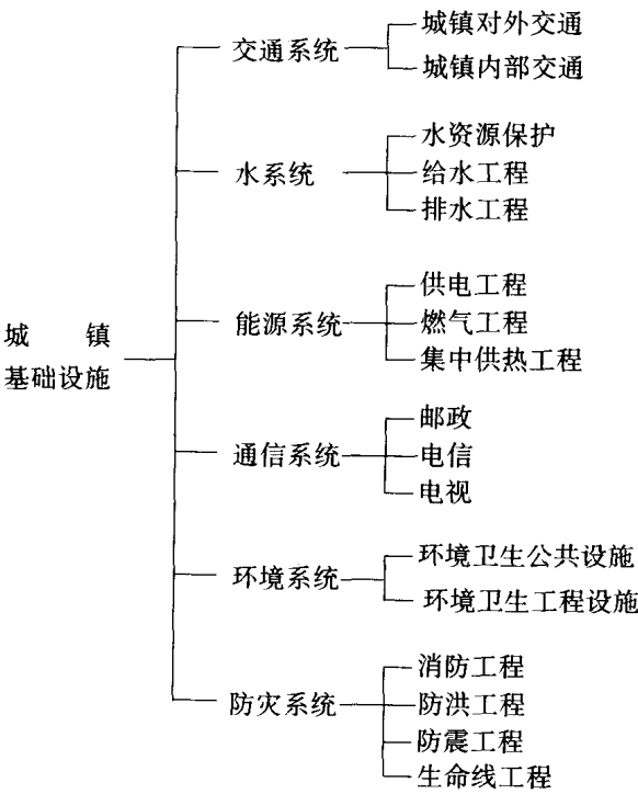
图 1.1 小城镇基础设施分类构成图
