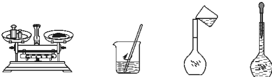
A. 称量 B. 溶解 C. 转移溶液 D. 定容
