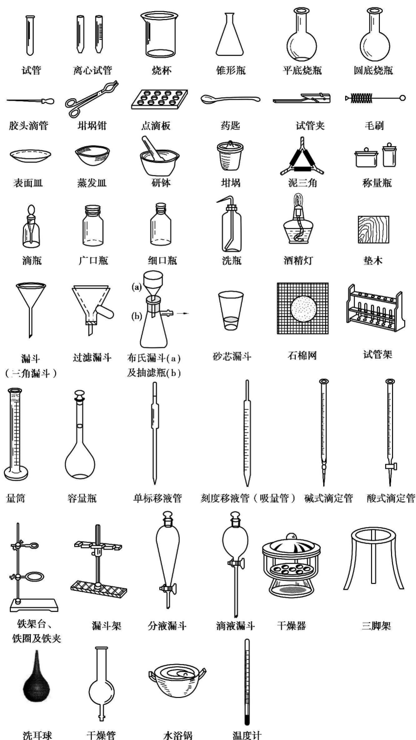
图 1-1 化学实验常用玻璃仪器及器材
