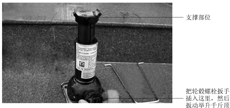
图 1-9 螺旋千斤顶
