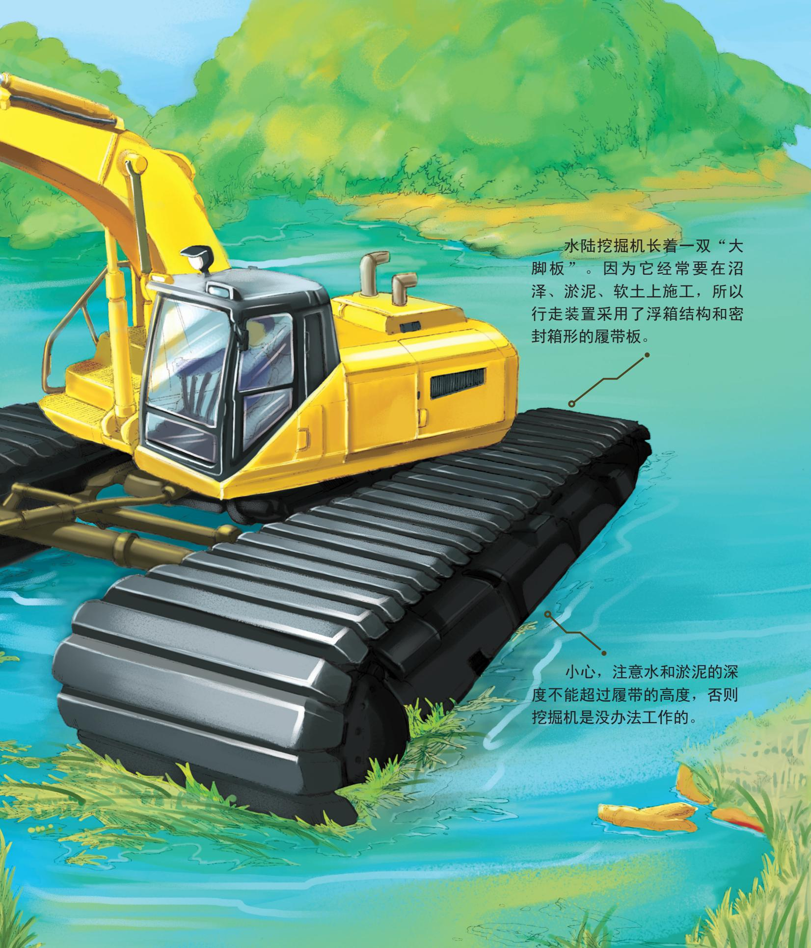
水陆挖掘机长着一双“大脚板”。因为它经常要在沼泽、淤泥、软土上施工，所以行走装置采用了浮箱结构和密封箱形的履带板。
