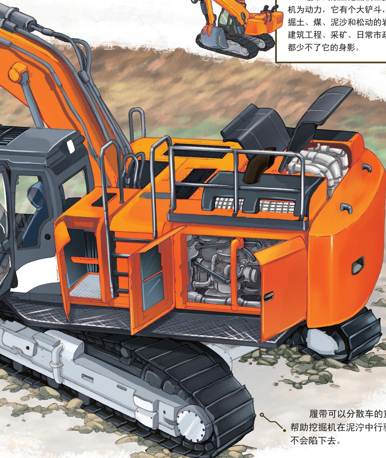
履带可以分散车的重量，帮助挖掘机在泥泞中行驶，而不会陷下去。
