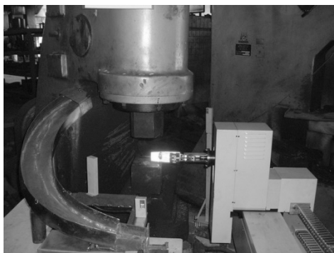
图 1-2 机械手操作自由锻
