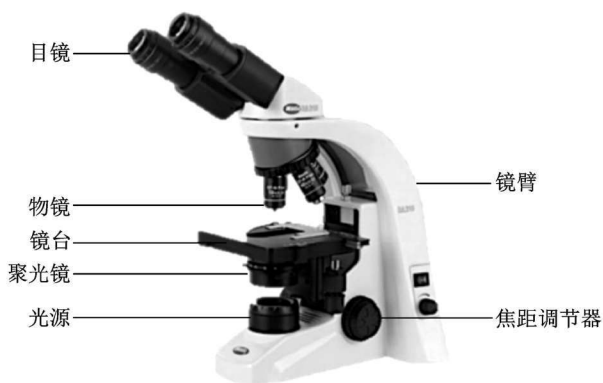
图 1-1 光学显微镜的结构图
