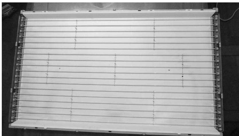
图 1-13 冷阴极灯管实物图
