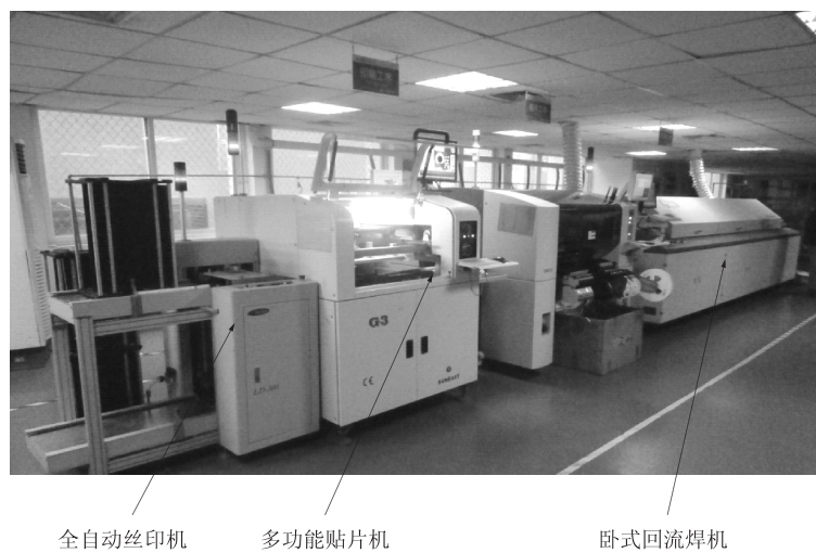
图 1-5 中小型 SMT 生产线的组成
