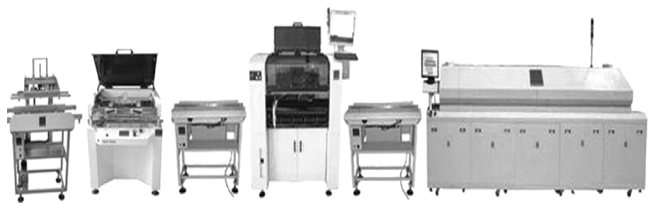
图 1-4 小型 SMT 生产线的组成
