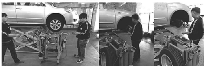
改进2: 气路系统, 无需频繁连接气源, 效率高
