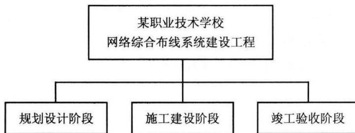
图 0-5 综合布线系统建设流程关系
