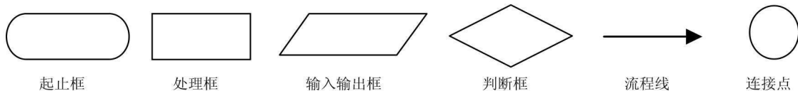
图 1-1 流程图基本构成图形
