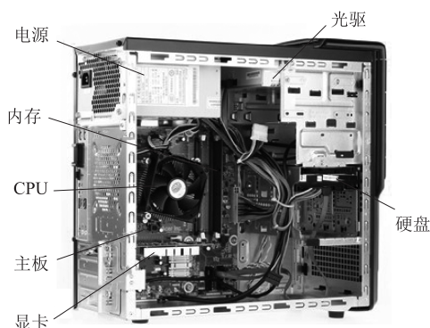
图 1-8 主机内部基本结构
