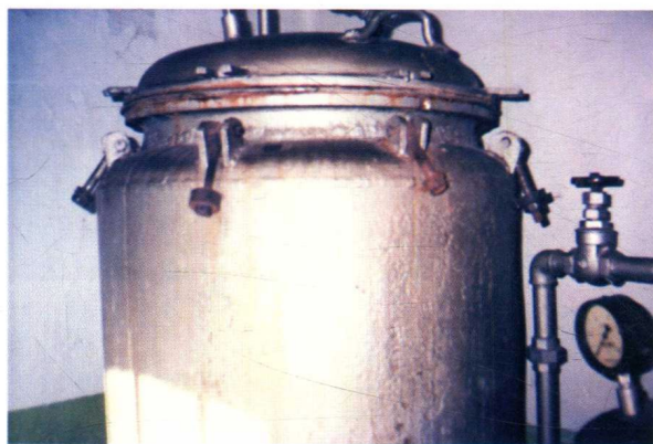
照片6 自制简易高压灭菌锅
