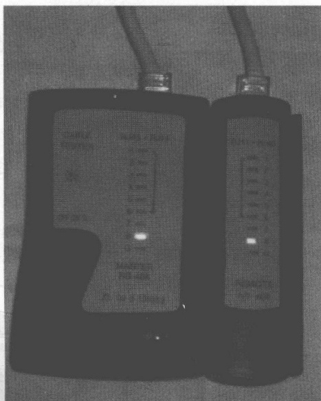
图 1-1-8 用测线仪检测网线
